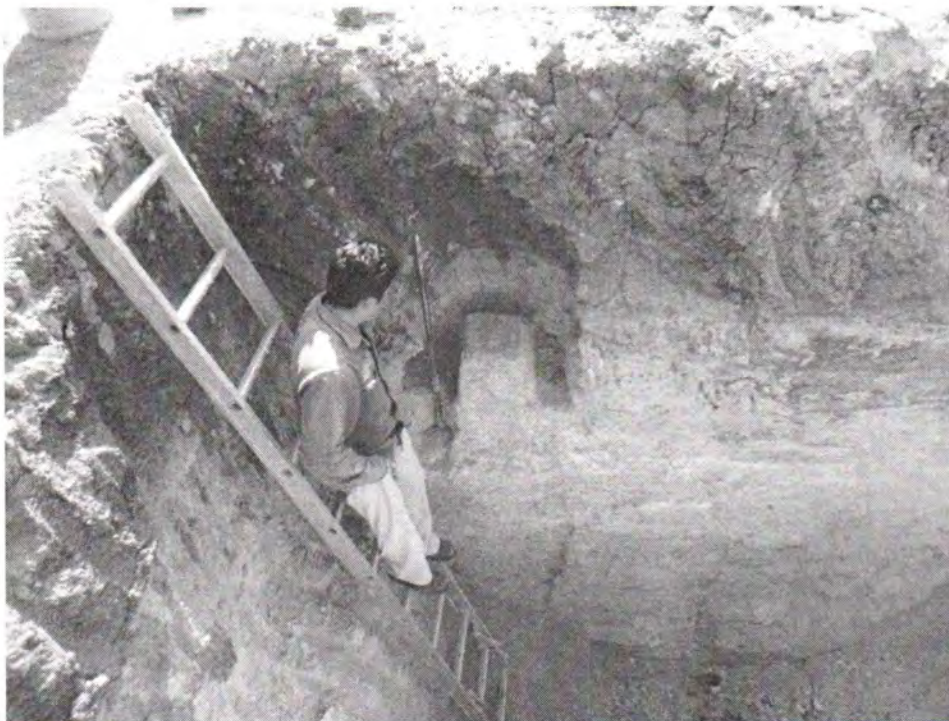
Recuperación de muestra inalterada estrato #2 sondeo PCA-1
