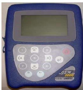
Figura 3.- Analizador de biogás. GEM 2000 plus de CES LANDTEC.
