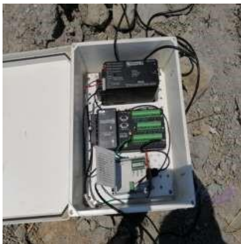
Figura 5. Equipo para la medición de velocidad del flujo de biogás.
