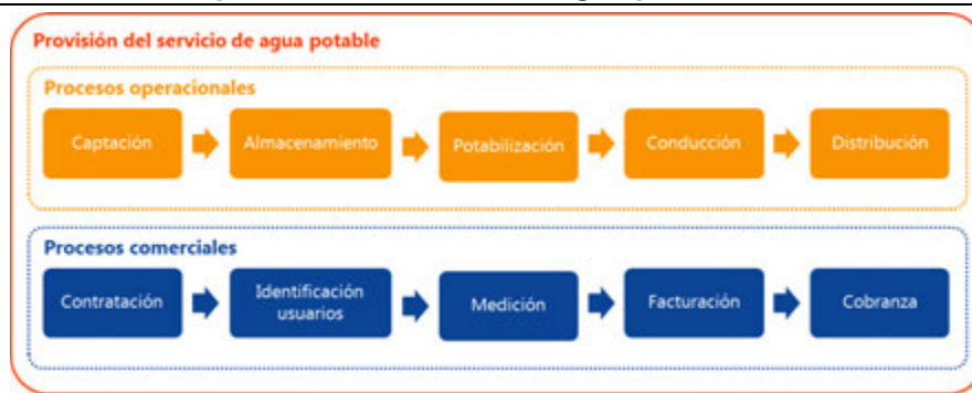
Figura 3. Procesos esenciales de la provisión del servicio de agua potable
